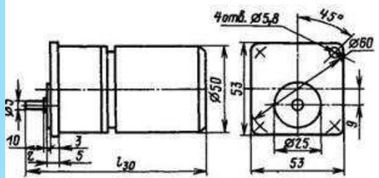
Двигатели имеют короткозамкнутый ротор типа «беличья клетка». Двигатели снабжены редукторами с передаточными отношениями 1 : 75 и 1 : 30. Крепление двигателей — фланцевое. Режим работы — продолжительный (S1).
