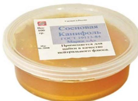
Перед началом пайки разогретый паяльник сначала "макают" в канифоль, затем жалом паяльника дотрагиваются до припоя, после чего уже прикасаются к месту спаивания деталей. Количество канифоли здесь играет немаловажную роль и жалеть ее не надо. Есть и другие способы нанесения канифоли, например, поднося кусочек к месту пайки, так например лудят вывода радиоэлементов или залуживают провода, всё зависит от конкретного случая.
