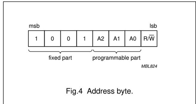
Fig.4 Address byte.
