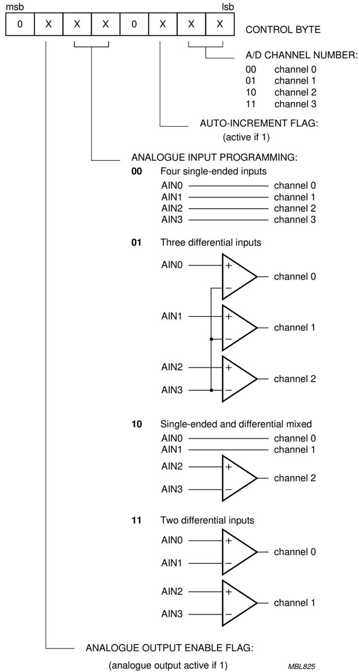
Fig.5 Control byte.
