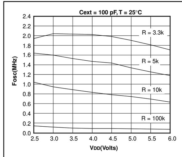
**FIGURE 21-7: TYPICAL RC OSCILLATOR FREQUENCY vs.  $V_{DD}$**
