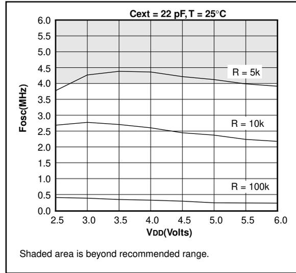
**FIGURE 21-6: TYPICAL RC OSCILLATOR FREQUENCY vs.  $V_{DD}$**
