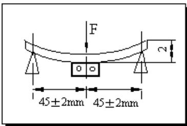
将产品按图焊在  $1.6\pm 0.2\text{mm}$  的 PCB 板中间，由箭头方向施力： $1\text{mm/S}$ ，弯曲距离： $2\text{mm}$ ，保持  $5\pm 1\text{S}$ ，产品金属层无脱落。
